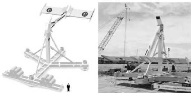
شکل ۸-۱۰ ژنراتور هیدروالکتریک از نوع گلايدر استینگری ۱ [BEN 09-02]
