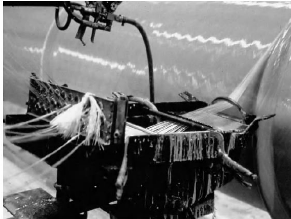
شکل ۱۲-۱۶ کاربرد اولین لایه (داخلی) فیبر شیشه‌ی بافته‌شده؛ به حلقه‌های تقویتی توجه کنید که مقاومت در برابر له‌شدگی را افزایش می‌دهند (منبع: Luis Vega)
