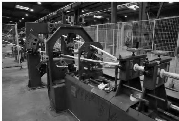
شکل ۱۵-۲۰ مونتاژ یک بخش برای تولید رسانای مجزا
