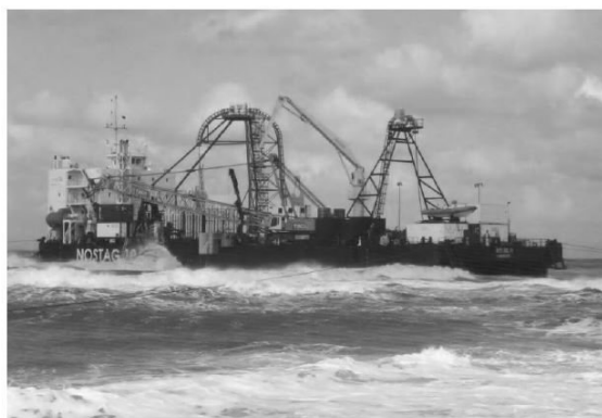
شکل ۱۵-۱۵ شناور حمل کابل زیر آبی
