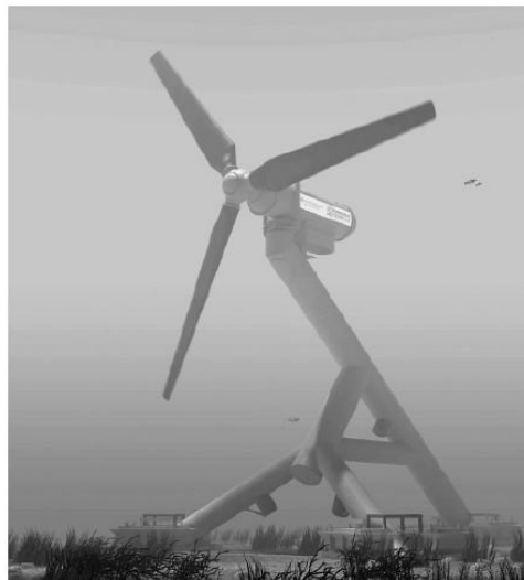
شکل ۵-۹ شماتیکی از توربین همرفست استروم (منبع: Euroviews)
