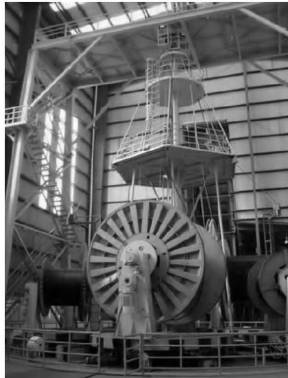
شکل ۱۵-۲۵ ماشین لایه‌گذاری عمودی به همراه قرقره‌های خود
