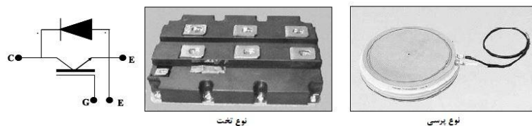
شکل ۱۴-۹ و IGBT و IGET ، فنآوری دو بدنه ای
