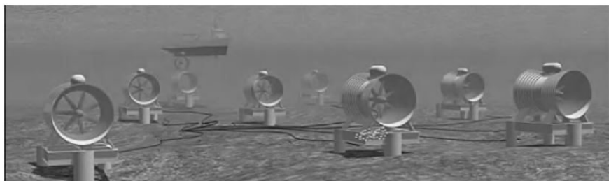
شکل ۹-۶ شماتیکی از توربین‌های لونا انرژی (منبع: LunarEnergy)
