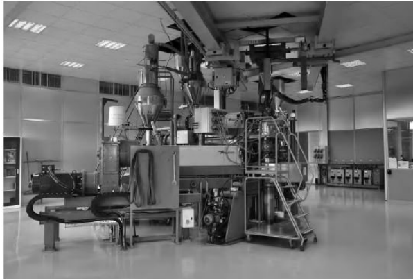
شکل ۱۵-۲۲ مجموعه‌ی اکسترودرها برای تولید کابل‌هایی تا 500\text{ kV}
