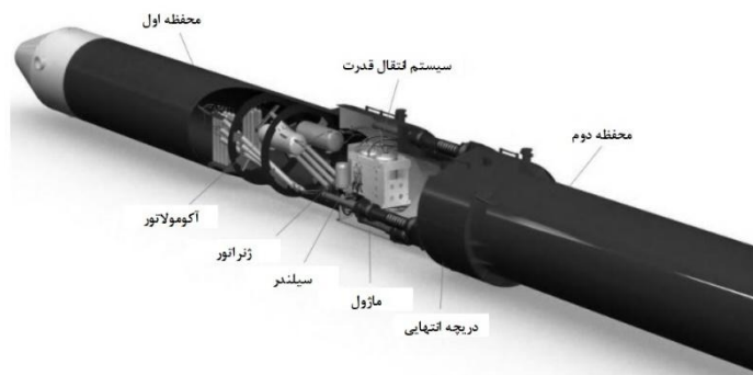
شکل ۱۱-۲۴ تصویری با جزئیات بیشتر از بخش تبدیلی مفصل پلامیس P2[PEL]
