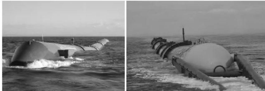
شکل ۱۱-۲۲ سیستم پلامیس (چپ: مدل P1 و راست: P2 ) [PEL Ltd]
