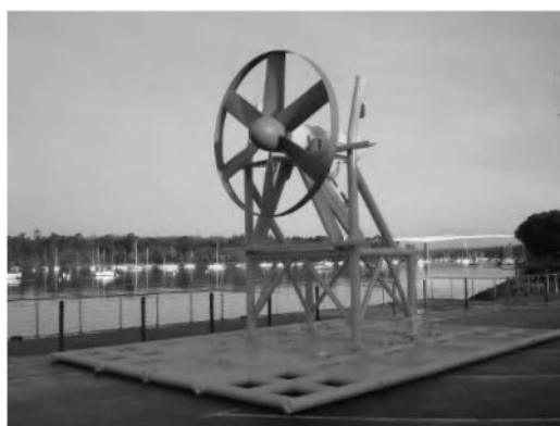
شکل ۱۰-۶ عکسی از نمونه‌ی اولیه‌ی Sabella D03 در بنودی قبل از اینکه به آب فرو برده شود. به ستون‌های راهنما بر روی پایه توجه کنید که بازوهای متقاطع توربین بر روی آن قرار داده خواهند شد (© Sabella SAS)
