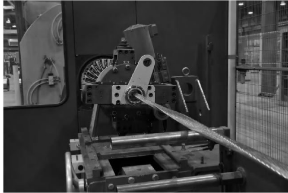
شکل ۱۵-۱۹ تولید بخشی (سیکتور) از هسته‌ی مجزا
