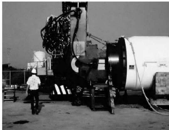
شکل ۱۲-۱۸ با استفاده از گیمبل مضاعف، رول و پیچ سکو بر CWP تأثیر نمی‌گذارد (منبع: Luis Vega)
