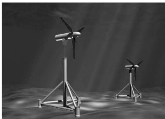
شکل ۹-۹ شماتیکی از توربین‌های TGL (منبع: TGL)
