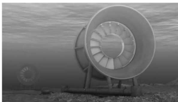
شکل ۸-۹ شماتیکی از توربین های OpenHydro (منبع: OpenHydro)
