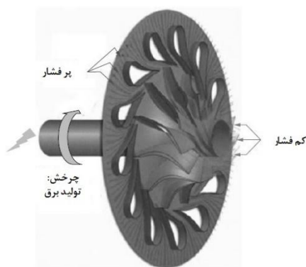
شکل ۱۴-۱۳ روتور شعاعی توربین (منبع: Cryostar) (به منظور مشاهده نسخه رنگی این تصویر لطفاً به سایت www.iste.co.uk/multon/marine.zip/ مراجعه نمایید)
