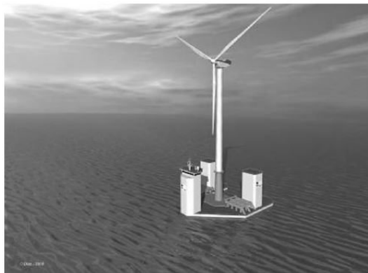
شکل ۵-۱۳ شماتیکی از بارج نیمه‌مغرق برای حمل و نصب توربین از قبل مونتاژ شده بر روی پایه‌ی بتنی (Saipem©)
